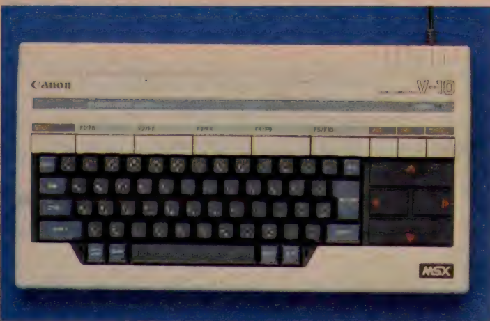
●非斜に二文字は斜に印刷を施してある平面形 ●上表面、側面、キーはすべてスチール製、塗装はカラーされている
