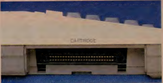
↑左側面のカバーを取りはずすと、スロットがあらわれる
