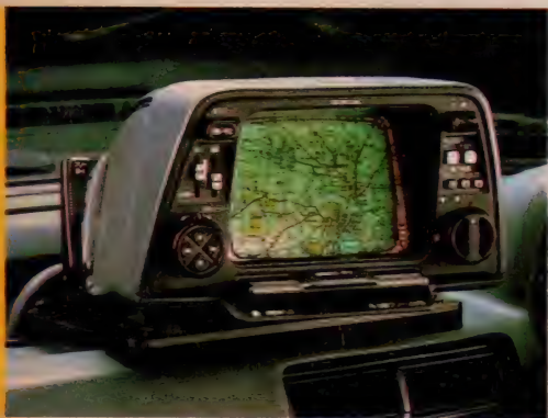
→ホンダのエレクトロ・ジャイロゲータ 透明の地図シートをさし替えて使う
