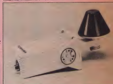
コンバータ。ここで衛星の電波BSチューナに供給できるように変換する。
