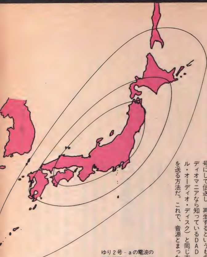
ゆり2号-aの電波の照射範囲まん中から60cm、75cm、1mのアンテナを使う。
