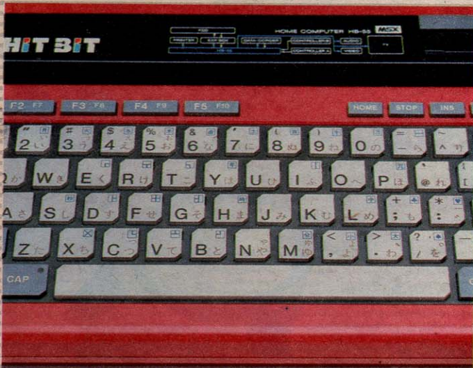
▲ソニーHB-55。キー配列:50音配列、キータイプ:タッチキー、キャラクタ表示:あり
