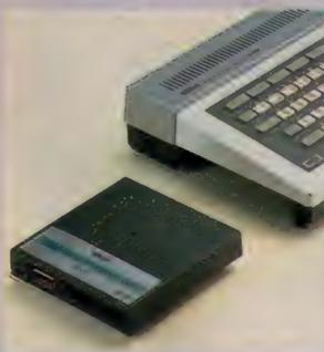
「ここが違う」の決定打はこの「サイドスロット」。ヤマハ独自の「拡張ユニット」を直接装着して本体内に格納でき、マシンを本格的な「ミュージックコンピュータ」や「ワープロシステム」に変身させます。
