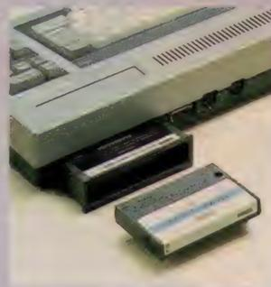
そしてさらに「リアスロット」。YIS 503だけのスロットで、シングルカートリッジアダプタを介して各種カートリッジを接続使用できるため、コンピュータ活用機能の質と量が大幅に広がります。
