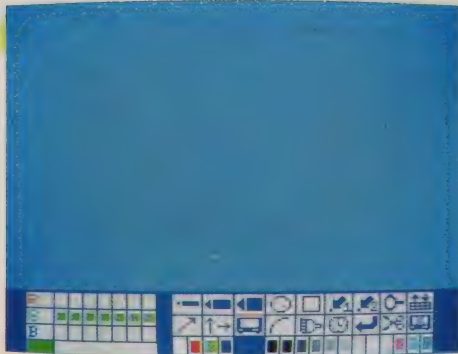
▲ MPC Xのモード切替スイッチの“MPC X”を押して、Mのコンピュータ画面を出す。ライトペングラフィックスカートリッジのコマンド・テーブルが表示された状態の画面。青色部分が作画エリア。左下端に、今指定されている緑色が表示されてる。
