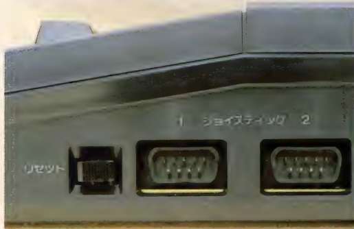
◆本体右側面のジョイスティックポートとリセットキー。
