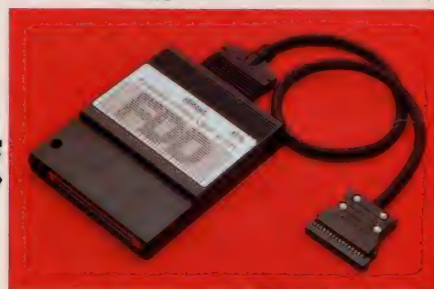
◆右の端子をMSXに、左は増設用端子輸出を意識してか電源部には余裕がある ◆別売のインターフェイスカートリッジ
