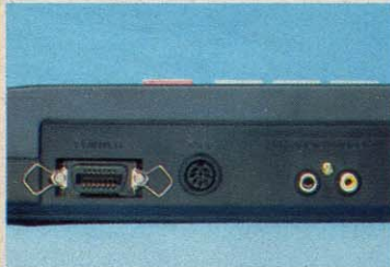
◆左からプリンタ・インターフェイス、カセット・インターフェイス、オーディオ出力、ビデオ出力。
