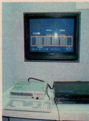
◆ベータプロを2台つなげた、簡易ビデオ編集システム。核となるのはMSX2。 ◆新型のディスク(2DD)。参考出品。
