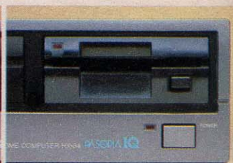
◆記憶容量1メガバイトのフロッピーディスク・ドライブ。使用のメディアは、もちろん3.5インチだ。
