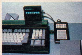
◆参考出品の手書き文字認識カートリッジ。BASICのコマンドも入力することが可能。 ◆中央の黒い箱がAVアダプタ。ML-G10につなげることで、デジタイズなどの機能が使えるようになる。
