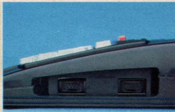
◆キーボードはステップスカルプチャータイプ。右側面にジョイスティック・ポートがある。
