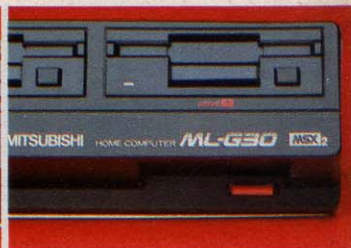
◆2DD方式で1メガバイトの記憶容量を達成したフロッピーディスク・ドライブ。写真はドライブ1。
