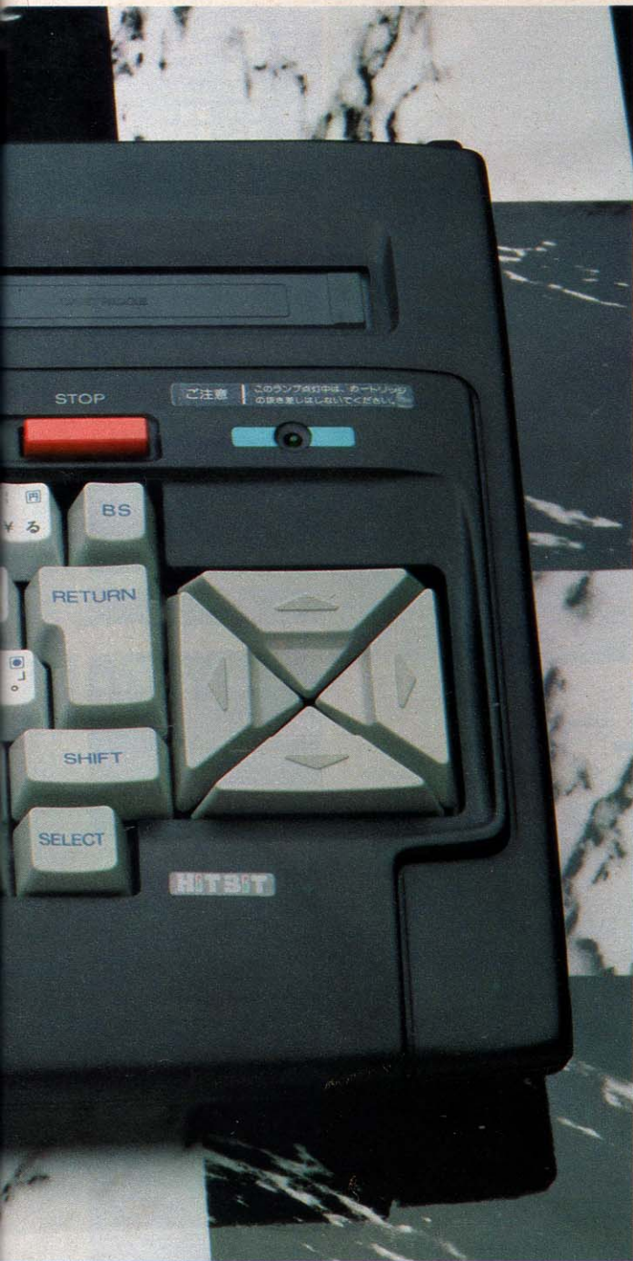
◆キーボードはステップスカルプチャータイプ。右側面にジョイスティック・ポートがある。
