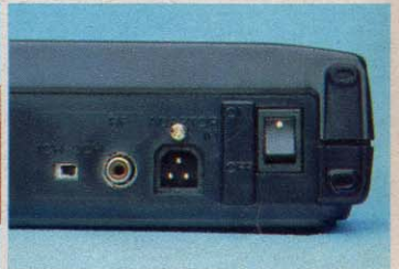
◆本体軽量化のため、電源部はACアダプタを使用している。左にある端子は、RF出力。
