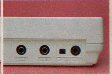
◆コンポジット出力の他に、RF出力も内蔵されているので、家庭用テレビとの接続も簡単にできる。
