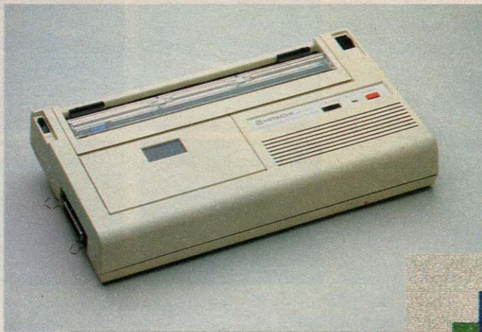
カラープリンタ・MPP-1022H。 MPP-1022Hには2種類のインクリボンが付属する。ひとつは、一般的なブラック。もうひとつがカラー印字のためのものだ。カセットの取り換えはごく簡単。下の絵は前ページの「絵はがき用ワープロ」で描いた画面をカラーコピーしたもの。かなりの表現力があるといえる。
