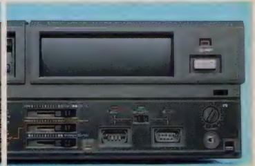
◆ボールマウスはジョイスティックポートを兼用している。場合にに応じてポート1と2を使い分ける。
