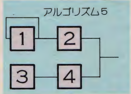
図2 オペレータ1が他と違うのはフィードバックがかかっていて、自分自信を変調してしまう。
