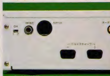
◆前面パネルをシンプルに仕上げたため、ジョイスティック・ポートは後面に設けられている。
