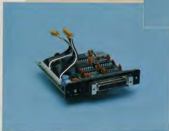
◆HX-34用RS-232Cインターフェイスキット、HX-R703。組み込みはドライバー1本
