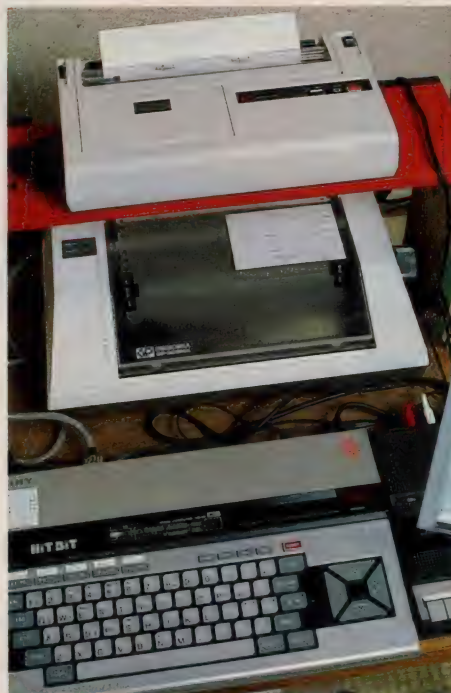
▲MSXマシンはSONYのHB-55。プリンタはセイコー社のドットプリンタGP-500MXと、サンヨーのカラー・プリンタMPT-C10の2機種。プリント・アウトはハードの性質、余でございます。
