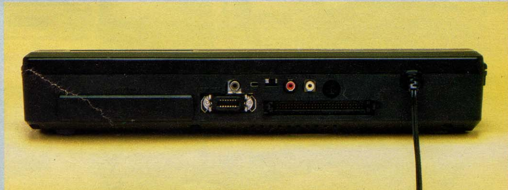
◆後面スロットに蓋をしてみると、リアパネルはこのようにスッキリする。音声/映像出力はおなじみの3方式。
