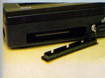
◆後面のスロットには、通常カバーが付く。
