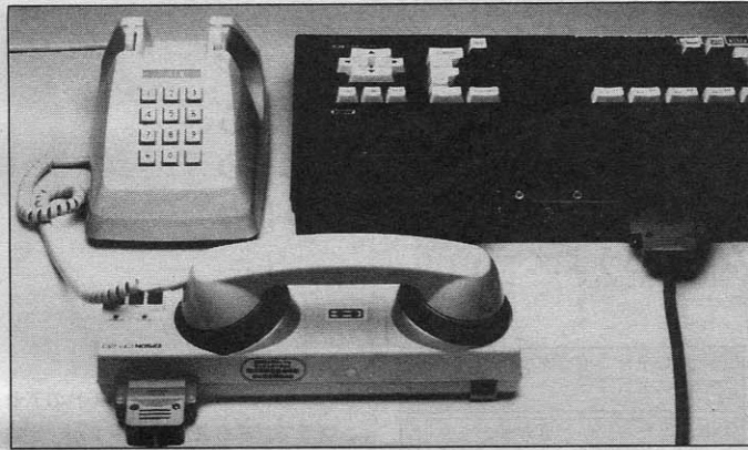
カブラを使ったMSXの通信システム例
