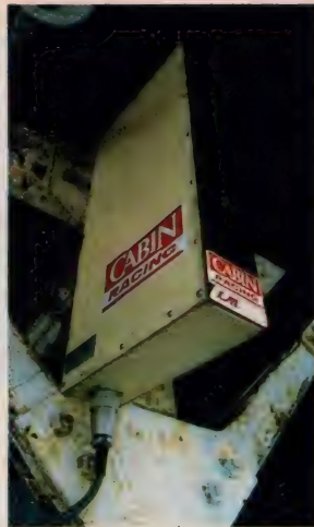
●ピットイン用の受光器も付いている。 ●(写真4)赤外線発信器を取り付けたところ
