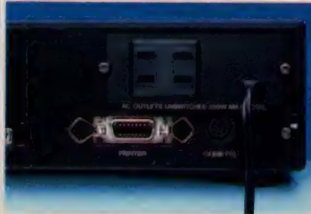
◆AC電源を2系統持たせたのはさすが。電源部は相当に強化されているようだ。またアース端子も設けられた。
