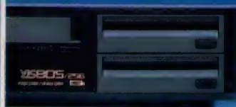
◆コンパクトに収まったディスクドライブ。YIS805/128では1ドライブが標準となるが、増設することは可能だ。
