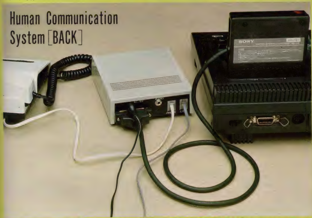
●RS-232Bケーブルは何処に、電話線は何処に配線されているのかをよく見てほしい。配線を誤るとネットワークへアクセスできないゾク
