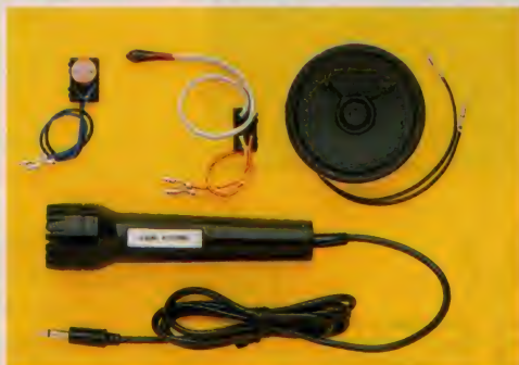
センサとして、CdS、サーミスタ、そしてマイクとスピーカが付属。すぐに楽しめる。
