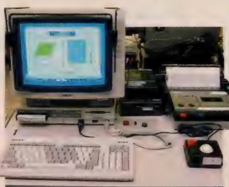
◆マシン、モニター、ディスクドライブ、データレコーダ、プリンタ……1人でこれらを全部使えます。
