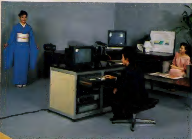
フルー無地の着物を着装し、銀無地の帯を締めた顧客本人の姿をカメラで撮影し、画像合成により着物の柄を重ね、好みに合うかどうかをモニター画面で確認する
