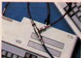
◀ホストと端末間の接続には、この高周波同軸ケーブルとT字形F接栓を使用。簡単手軽だ。
