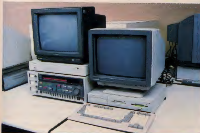
↑IF-2000・2001およびHC-95/90で構成されるVTRデコーダーシステム。ホテル内放送やCATVの送り出しを実現するためのVTRのアニメーションを利用する際のものとす。
