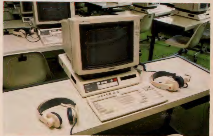
◆生徒側の学習ターミナル。キーボード2台で個別学習ができるが、北谷中学では1台のキーボードを2人で使って、協力し合いながら学習する方針を採用。モニター下部のエデュケーションユニットを操作して先生に質問したり、答えたりできるようになっている。
