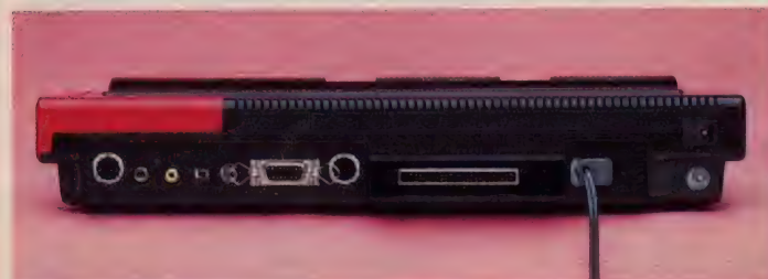
◆F1XDの背面パネル。左から順にRGB、オーディオ、ビデオ、チャンネル切り換え、RF、プリンタIF、カセットIF、カートリッジスロット、そしてアース端子。
