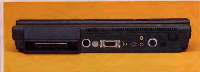
◆F1IIの背面パネル。左から順に、カートリッジスロット、カセットIF、アース端子、プリンタIF、チャンネル切り換え、RF、ビデオ(上)、オーディオ(下)、RGBの各端子。
