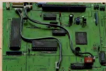
▼写真12 映像/音声回路(F1XD)
