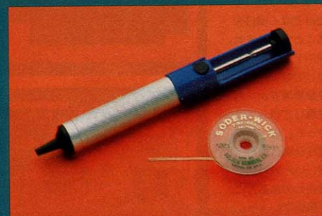
写真4 ハンダ吸い取り器 網式は400円位で、ポンプ式は1500円位から。
