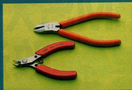
写真5 ニッパー 上が普通のタイプで、下が先の細いものです (1500円位~)。
