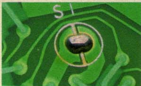
写真1 ジャパンSI ハンバーガのような丸形ランドに、ハンダがのっています。ハンダを吸い取り、中のスリットのところをカッターで切り離してください。
