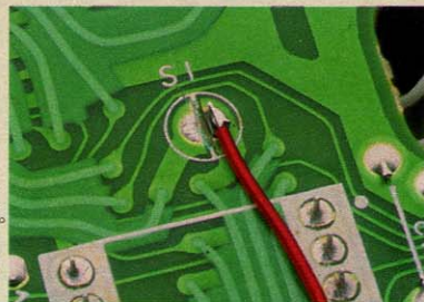
写真1 ジャパンSI ハンバーガのような丸形ランドに、ハンダがのっています。ハンダを吸い取り、中のスリットのところをカッターで切り離してください。
