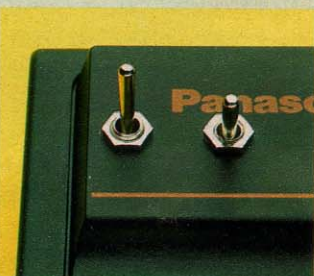
写真4 スwitchの取り付け スイッチは好きなところに付けますが、内部の金属部分とスイッチ端子が絶対に触れないようにします。もう一つのスイッチは、最後のところで使います。
