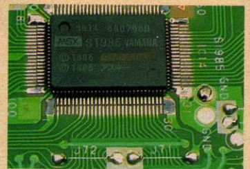
写真4 MSX-SYSTEM II ピン間の隙間が約0.5mmというシロモノ。普通の方法ではハンダづけできません。
