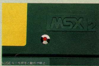
写真4 ▶LEDの実装 ブラケットタイプのLEDを付けています。奥行きが短いものでないとケースが閉まらなくなるので注意。
