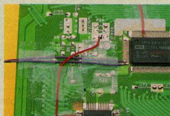
写真6 LSIのまわり ハンダづけ中はセロテープで配線を押さえ、はずれないようにします。終わったら接着材で固定しておくとう安心です。
