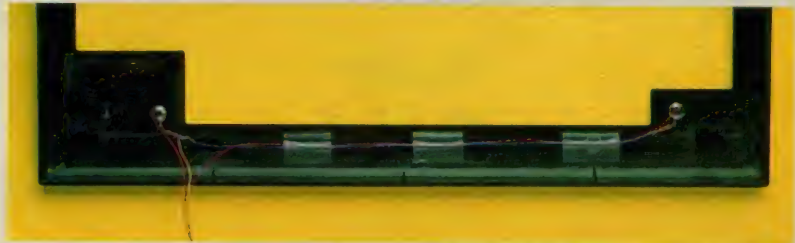
写真6 ケースの裏側 配線はセロテープなどでケースに固定しておきます。
