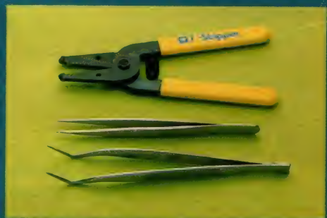
写真7 ワイヤストリッパーとピンセット ストリッパーはあると便利 (2500円位、ピンセットは600円位〜)。
