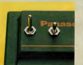
写真4 スwitchの取り付け スイッチは好きなところに付けますが、内部の金属部分とスイッチ端子が絶対に触れないようにします。もう一つのスイッチは、最後のところで使います。
