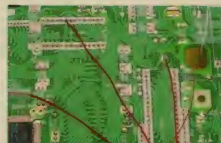
写真5 配線の引き出し ROMとジャンパから、配線を引き出しています。
