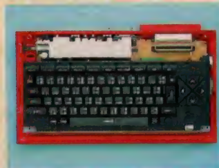
上側のケースを開きます。キーボードユニットを落とさないように！
