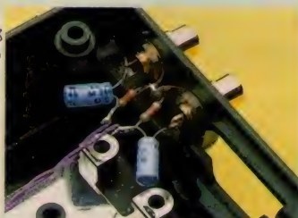
写真4 部品のハンダづけ 抵抗器とコンデンサは、固定したピンジャックにハンダづけします。また、グラウンドの配線も行ってください。
