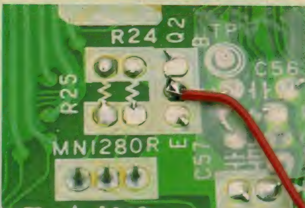
写真2 リセット信号の取り出し 回路図のポイントBは、トランジスタQ2のコレクタから引き出します。縦に3つならんだランドのまん中のピンです。
