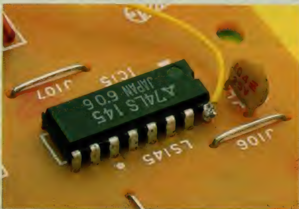
写真2 プラス5Vの取り出し 電源の+5Vは1C20の16番ピンから引き出します。
