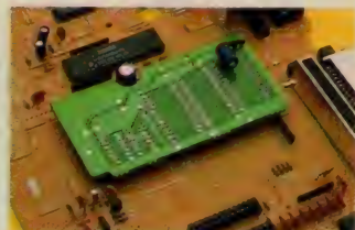
写真8 ROMまわりの違い これはROM基板のタイプのもので、配線はROMだけの場合と同じです。ROMが2段重ねになって配線が引き出されている場合は、図2の回路をします。
