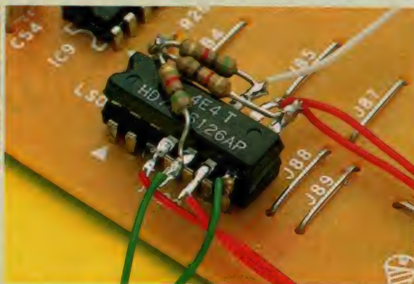
写真1 ICのビギンバック 74LS126の7番と14番ピンを下のTTL-ICに合わせ、ハンダづけします。固定と電源の供給を兼ねているわけです。手前の配線と抵抗器が、キー配列変更回路のもです。
