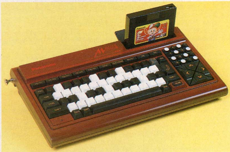
■これが、手作りMSXシンセサイザー。なんとFM音源を搭載で、ポリフォニック演奏が可能なのだ!
