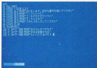
▲このように漢字の文字列をBASICプログラム中で使用することができる。
