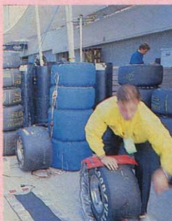
▶タイヤがグリップ力を発揮するのは摂氏80度前後とかな。
