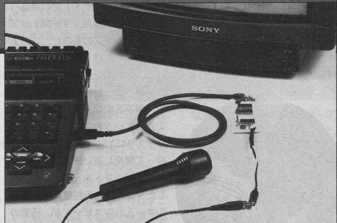
◆インターフェイスをMSXに接続して、マイクから拾った音の周波数を測定してみる。
