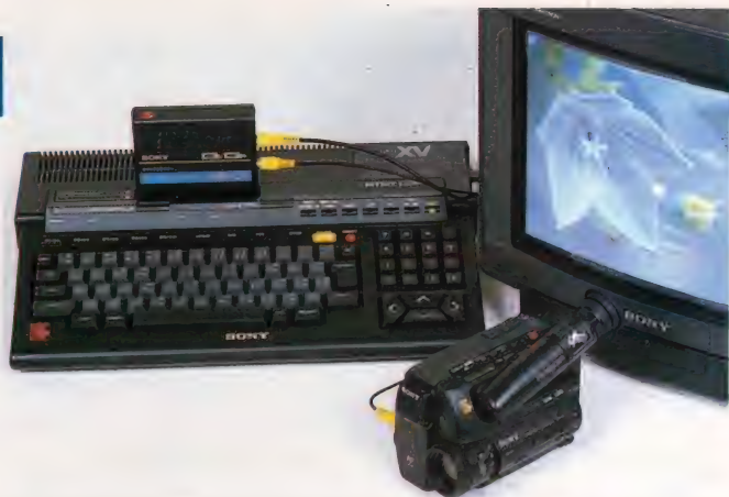
◆MSX2+マシンにHBI-V1、そしてビデオカメラとモニター。これが基本システムだ。
