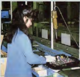
◆まずはケースの中に基板をセット。ビス止めるだけだから、アツという間た
