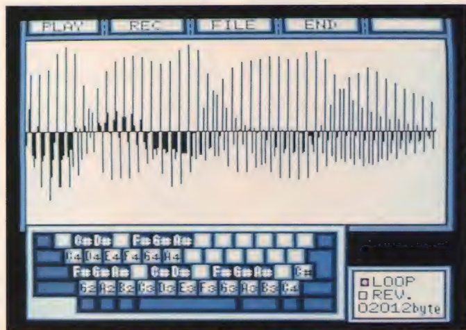
■同じ波形データでも、再生するときのスピードによって音階が変わってくるのだ。
